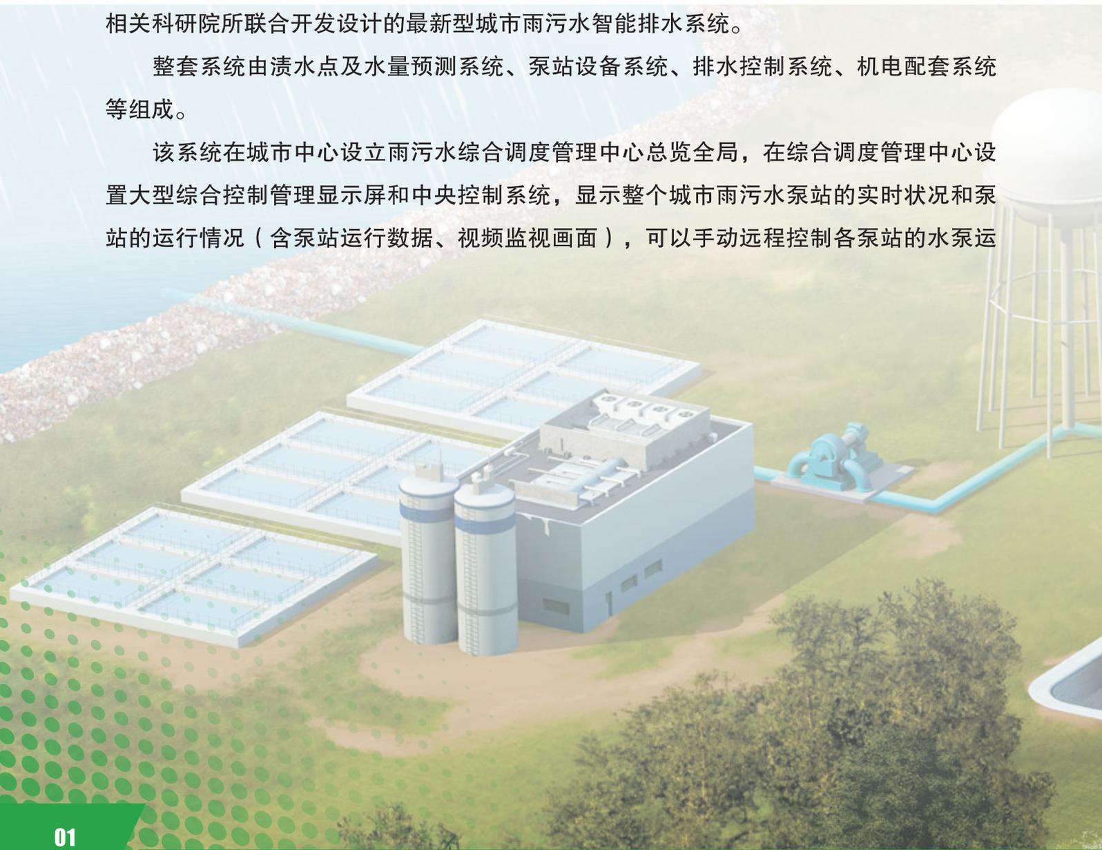
行，可以设定天气及水位条件、各泵站处的渍水情况自动智能控制城市整个泵站系统的运行，可以根据设定水位、渍水深度报警，可以打印及向特定的部门上传各种数据。
